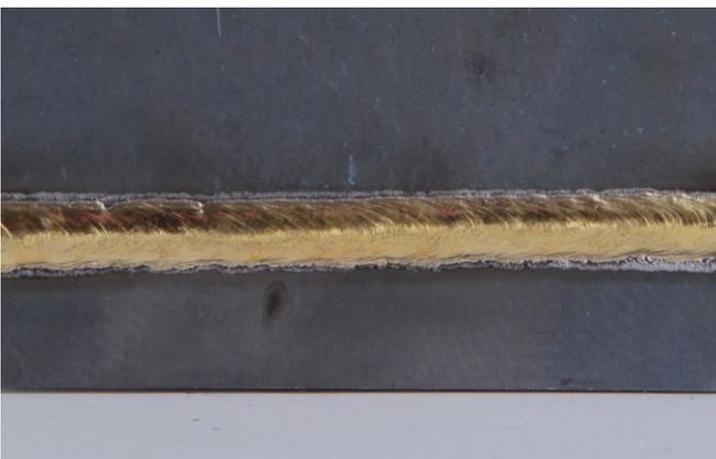
Brasage de tôles à haute résistance, par exemple Usibor<sup>®</sup>
