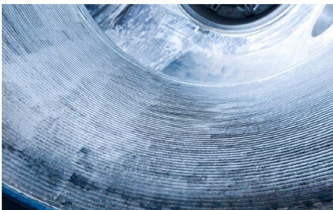
Nuovi varianti di processo, combinazione di un procedimento di saldatura MAG con un filo caldo aggiunto.
