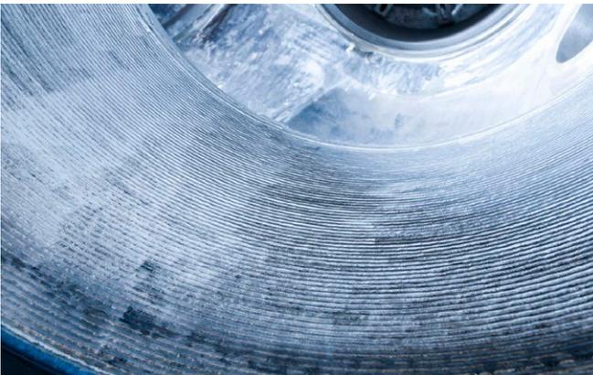
Nueva variante de proceso, combinación de un proceso de soldadura MAG con un hilo caliente alimentado de forma adicional.
