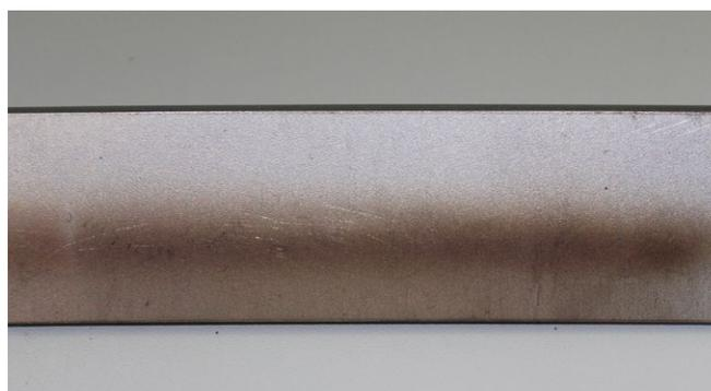
**Parte posterior:** escaso aporte de calor con forceArc puls<sup>®</sup>, menor oxidación de la superficie
