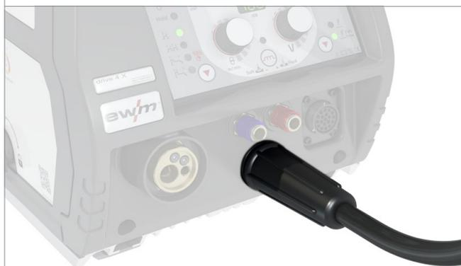
**Zócalo de conexión en el alimentador de hilo**
