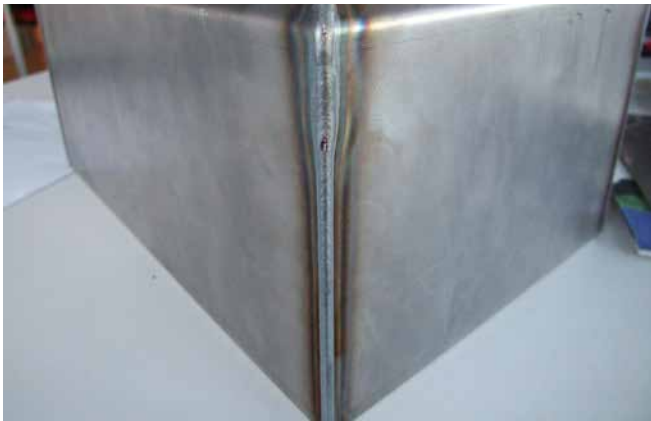
Schweißen von unlegierten Blechen
