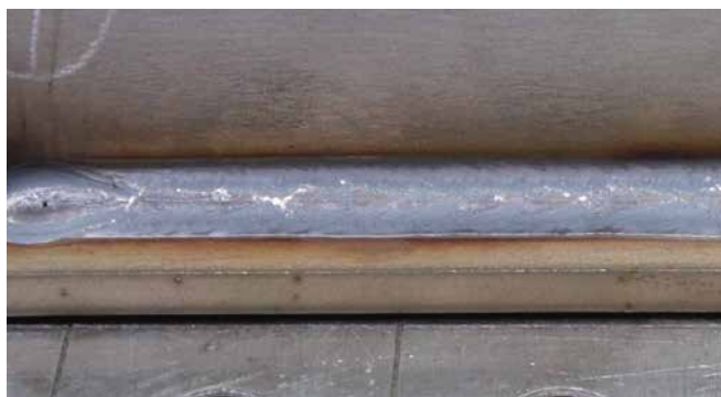
Parte frontal: menor aporte de calor con forceArc puls ® , menor oxidación de la superficie, por ende, mejor aspecto
