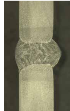
Chapa de 5 mm de grosor Separación 3 mm
