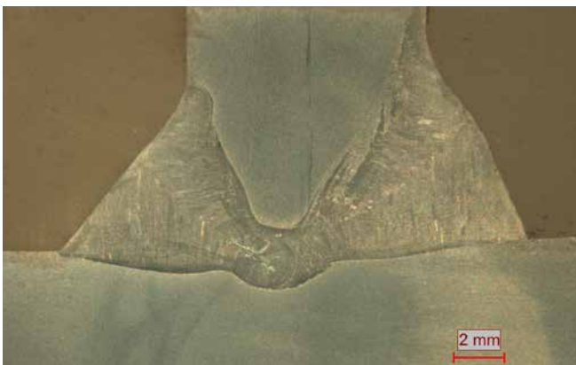
PB Conexión completa soldada en ambos lados
