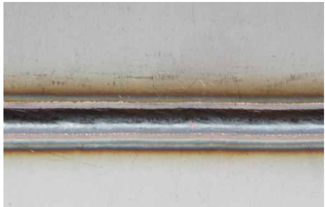
Soldadura de chapas de alta aleación
