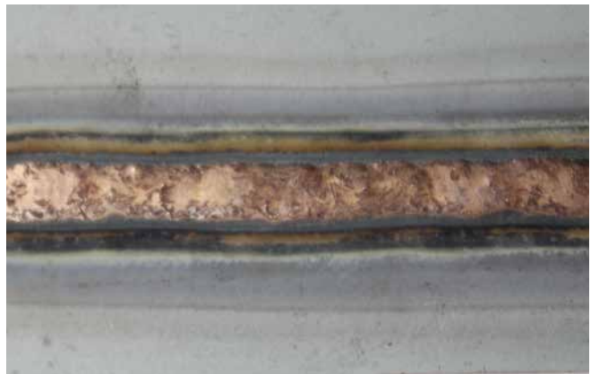
Brazing de chapas galvanizadas
