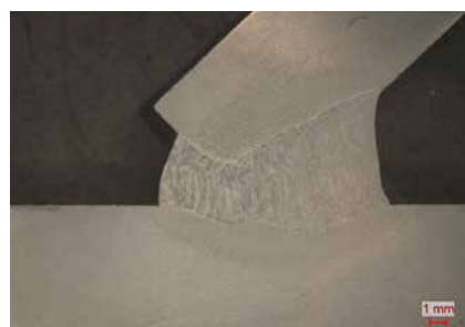
Épaisseur de tôle d'âme 10 mm, angle d'ouverture 35°
