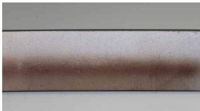
Face arrière : Apport d'énergie limité avec forceArc puls ® , moins d'oxydation de la surface
