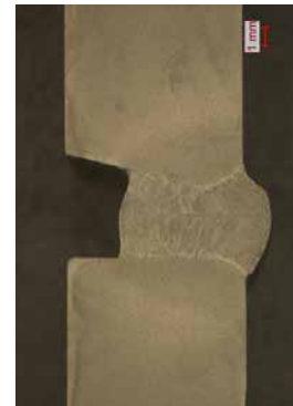
Épaisseur de tôle 10 mm, chanfrein d'un côté 15 degrés, jour 4 mm
