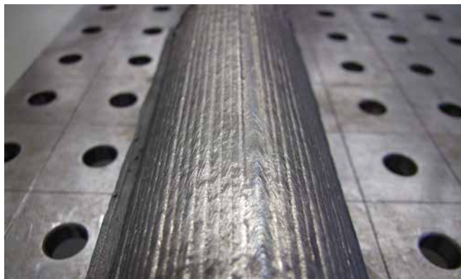
Rechargement résistant à la corrosion de métal Alloy 625 base Ni
