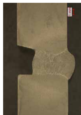
Grubość blachy 10 mm, skos jednostronny 15 stopni, szczelina 4 mm
