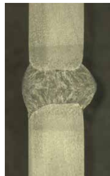
Grubość blachy 5 mm Szczelina 3 mm
