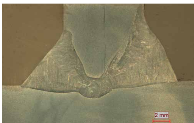
PB Spoina dwustronna z pełnym przetopem
