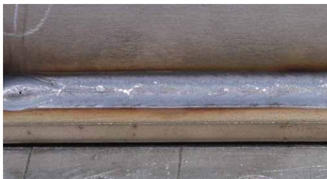
Ściana przednia: Mniejsze wprowadzanie ciepła w forceArc puls ® , mniejsze utlenianie powierzchni, dzięki czemu uzyskuje się lepszy wygląd spoiny
