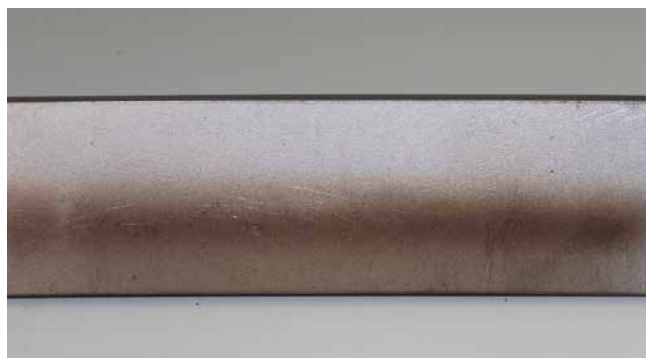
Ściana tylna: Mniejsze wprowadzanie ciepła w forceArc puls ® , mniejsze utlenianie powierzchni
