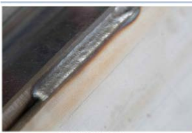
Abb. 6: Die MAG-geschweißte Kehlnaht in PB ist nahezu spritzerfrei.
