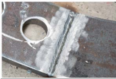
Abb. 4: Der von 60° auf 40° reduzierte Öffnungswinkel erfordert beim forceArc-Schweißen weniger Schweißraupen. Das reduziert die Schweißzeit und spart Kosten.
