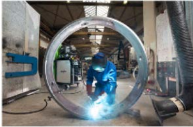
Abb. 3: Schweißen der X-Naht eines Stahlrings mit forceArc.
