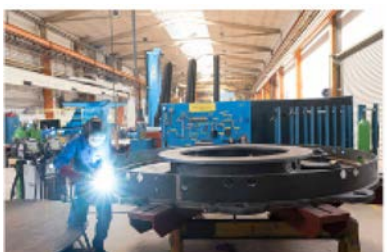
Abb. 2: Heften und Schweißen von Kehl- und V-Nähten am Glühsockel einer Haubenofenanlage in PA und PF. Die Stahl/Stahl und Stahl/CrNi-Verbindungen erfordern unterschiedliche Zusatzwerkstoffe, die beide gleichzeitig in dem Schweißgerät verfügbar sind.
