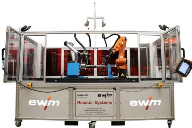
Mit dem flexiblen Komplettsystem zum Roboter-Schweißen bekommen Kunden von EWM eine schweißbereite Roboterzelle. Sie ist mit einer variablen Schutzhäuserüstung ausgestattet.
