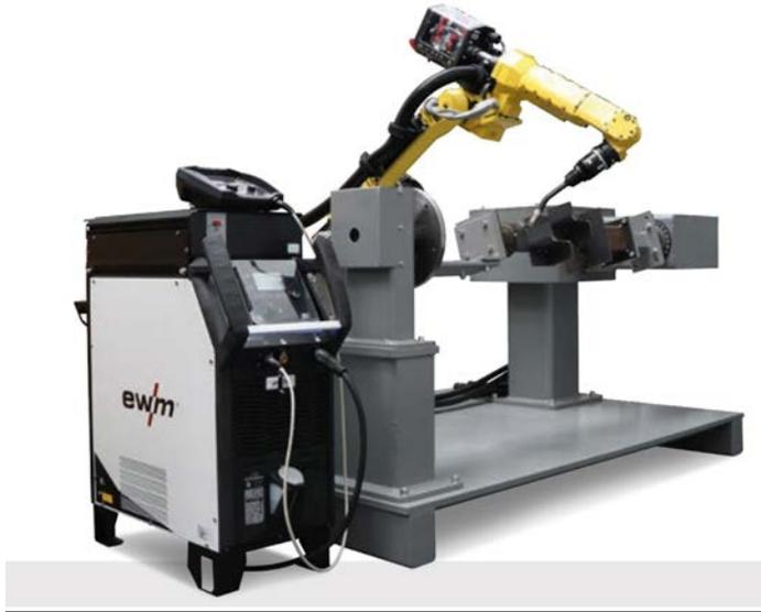
Auf Basis eines modularen Systems entwickelt EWM Komplettlösungen für das automatisierte Schweißen, die an die Anforderungen und Schweißaufgaben der Kunden angepasst sind.
