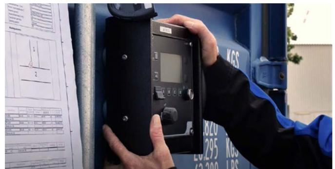
Das Gateway schafft die Verbindung zum ewm Xnet-Server und stellt für die Datenübertragung die Verbindung zum Scanner und zum Schweißgerät her.
