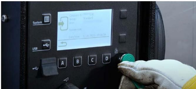
Mithilfe eines RFID-Schlüssels, dem Xbutton, meldet sich der Schweißer am Schweißgerät an. Damit sind auch seine Qualifikationen hinterlegt.
