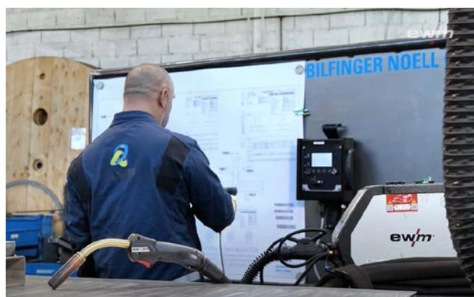
Der Schweißer scannt die zu schweißende Naht und kann dann direkt losschweißen – ganz ohne Bürokratieaufwand. Die Parameter werden automatisch am Schweißgerät voreingestellt.
