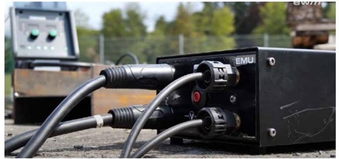
Mit dem Universal Logger lassen sich auch Schweißgeräte anderer Hersteller bei ewm Xnet einbinden – mit den gleichen Annehmlichkeiten einfacher Dokumentation.
