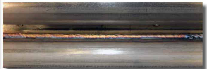
Eine WIG-Heißdraht-Schweißnaht. Die Naht für das nächste Halbrohr wird unmittelbar neben der ersten Naht liegen. So ist die höchste Belegung der Behälteroberfläche mit Kühlschlangen erreicht. Die Schweißnaht selber ist absolut spritzfrei.
