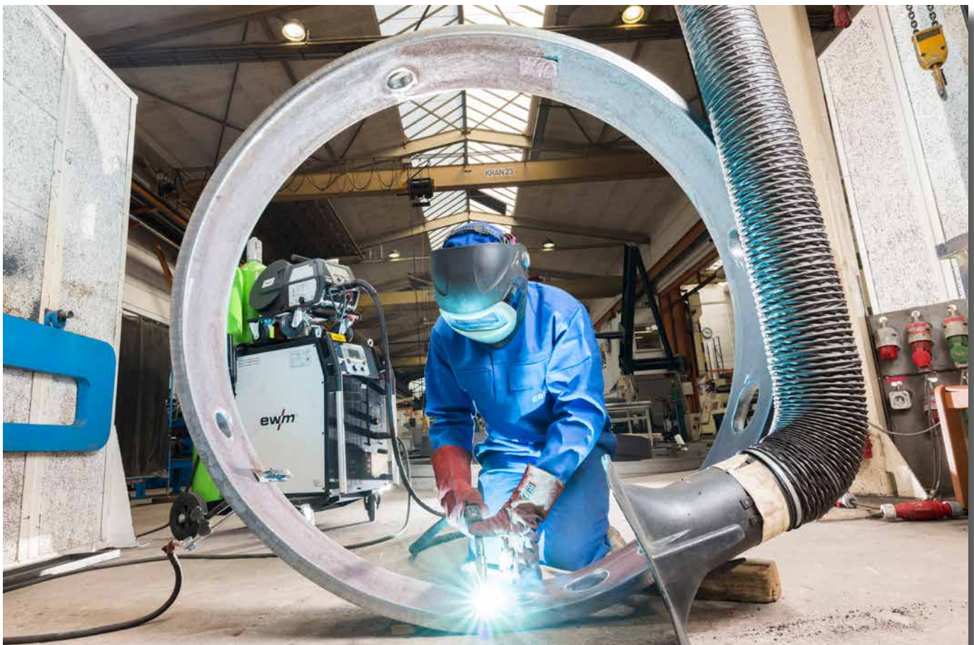
Schweißen der X-Naht eines Stahlrings mit forceArc
