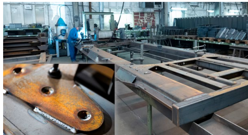
Das innovative Schweißverfahren forceArc puls wird in allen Bereichen des Stahlbaus zum Verschweißen unbehandelten Schwarzstahls eingesetzt. Die Prozesssicherheit ist hoch und die nahezu spritzerfreie Naht perfekt.
