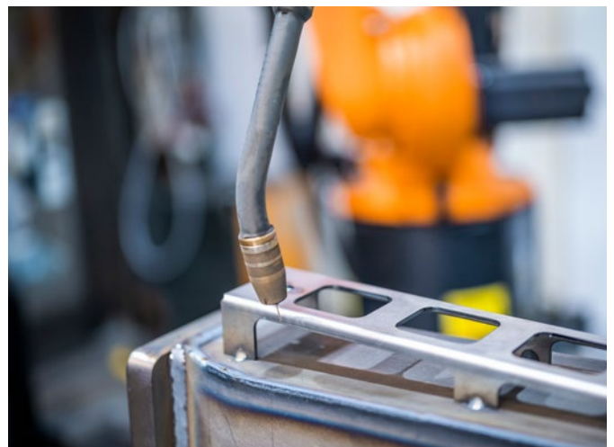
Der Roboter erkennt mithilfe des Schweißbrenners die genaue Position des aufgesetzten Bauteils. Er verwendet die Drahtspitze des Zusatzwerkstoffs als Messtaster und detektiert den Kurzschluss. Daraus leitet das Programm die genaue Position des Bauteils ab.
