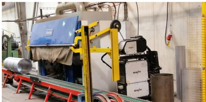
Die Rundbiegemaschine formt das Rohr ein, das anschließend direkt per MIG/MAG-Schweißverfahren verschweißt wird. Das Drahtvorschubgerät sorgt für den sicheren Transport des Zusatzwerkstoffs. Die verschiedenen Schweißverfahren bieten spritzerarme Nähte bei unterschiedlichsten Materialien, Materialdicken und Durchmessern.
