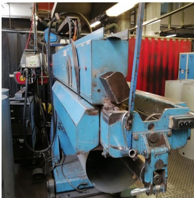
Die Naht befindet sich an der Oberseite des Rohres. Eine Achse führt den Brenner direkt oberhalb der Naht entlang. Die Nähte sind hochwertig und spritzerarm. Das Drahtvorschubgerät sorgt für den sicheren Transport des Zusatzwerkstoffs.
