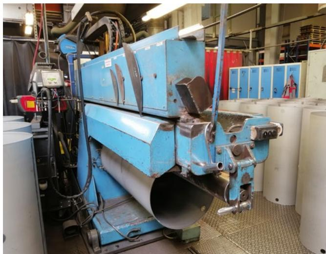
Das eingeformte Rohr befindet sich unten in der Anlage, die Schweißnaht befindet sich oben mittig. Eine Achse positioniert den Brenner exakt auf der Naht. Das sorgt für eine sichere und spritzerarme Schweißung.
