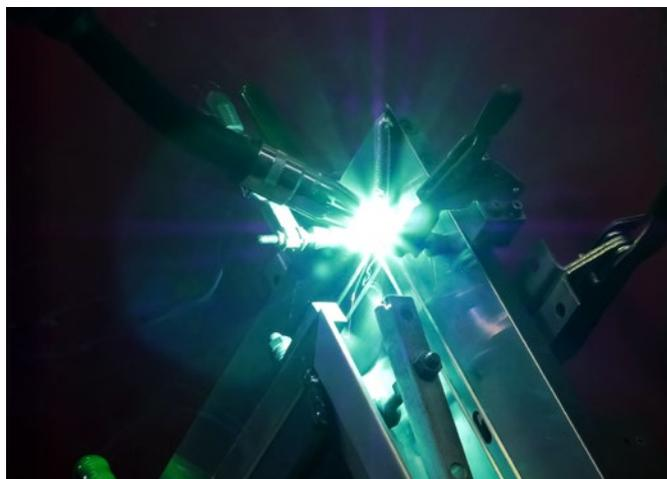
Der neuartige Schweißprozess ermöglicht eine volle Kontrolle des Tropfenübergangs und damit spritzerfreie Ergebnisse.
