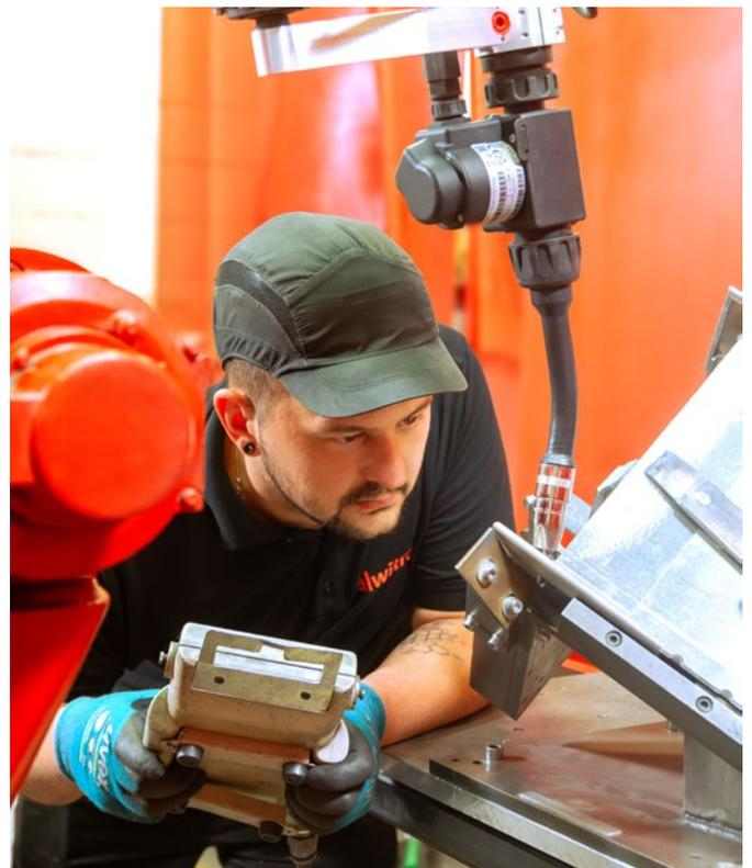
Durch die hohe Abschmelzleistung lassen sich mit EWM React Bauteile schneller schweißen. Gleichzeitig verringert sich die Nacharbeit erheblich, wodurch pro Werkstück eine Zeitersparnis von einer Minute erzielt werden konnte.
