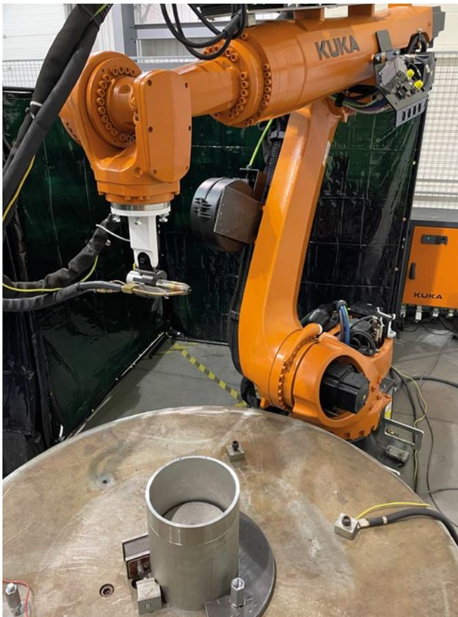
Das Schweißverfahren forceTig® ermöglicht in Verbindung mit der TANICS™-Lösung eine präzise, reproduzierbare Bahnführung des Roboters, auch bei komplexen Nahtprofilen wie Kurven.
