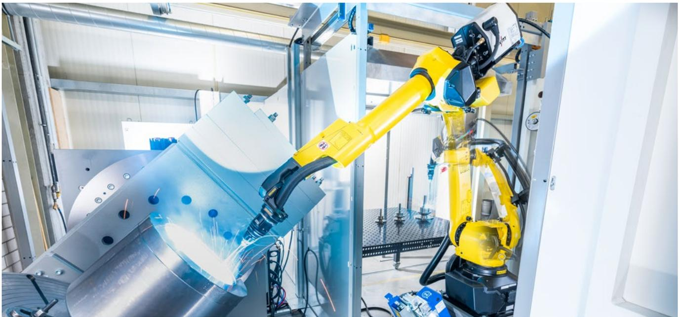
Weichpanzerung eines Ventilkörpers. Der Zusatzwerkstoff wird über den Drahtvorschub drive 4X auf dem Roboterarm sicher gefördert.
