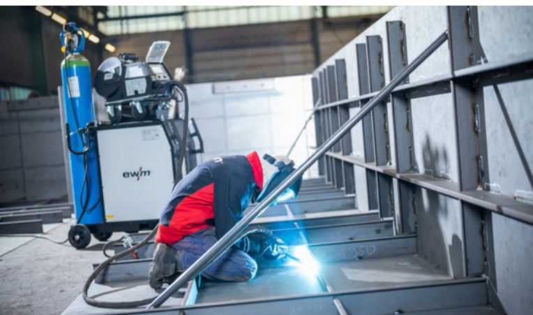
Täglich bearbeitet die Heinrich Döpke GmbH bis zu 22 Meter lange Bauteile aus Schwarz- und Edelstahl. Seit 2020 mit dem EWM-Schweißgerät Titan XQ 350 puls mit Drahtvorschub und EWM-Schweißbrenner PM 451.
