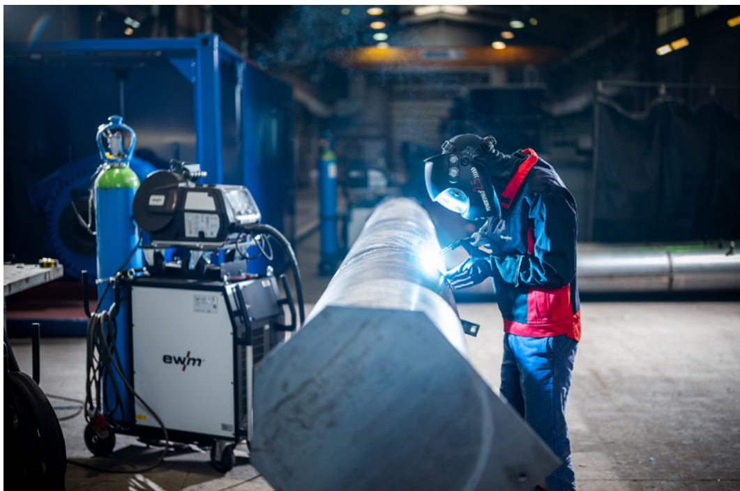
Auch Saugrohre hat Döpke als Verschleißteile im Sortiment. Sie werden ebenfalls in den Hallen im Gewerbegebiet in Norden geschweißt.
