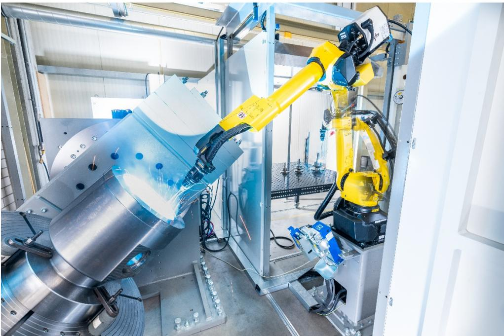
Weichpanzerung eines Ventilkörpers. Der Zusatzwerkstoff wird über den Drahtvorschub drive 4X auf dem Roboterarm sicher gefördert.
