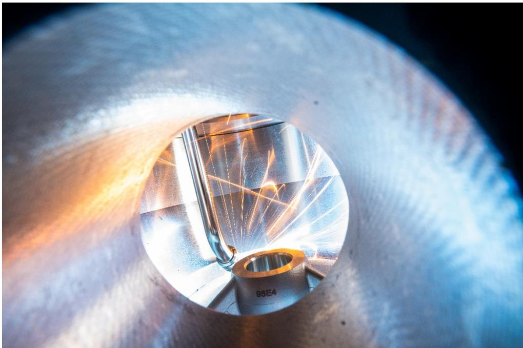
Dank der neuen Brennerkonstruktion: sicher schweißen trotz beengter Platzverhältnisse.
