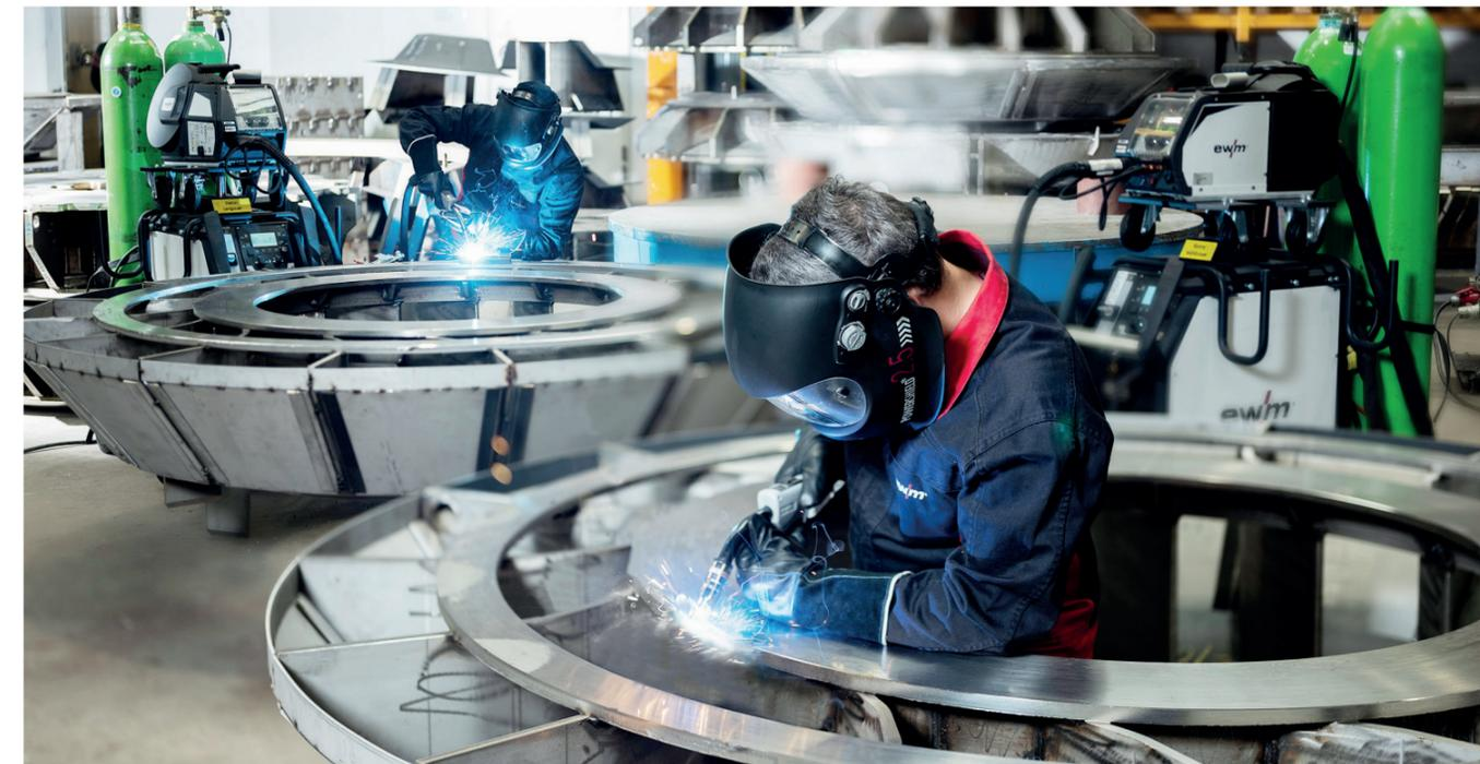
Die dekompaten Titan XQ puls mit zwei Drahtvorschubgeräten und zwei Gasflaschen macht das Arbeiten am Bauteil einfacher. Der Schweißer greift sich einfach den anderen Brenner und kann so unterschiedliche Lagen mit verschiedenen Schweißdrähten und Schweißgasen schweißen.
