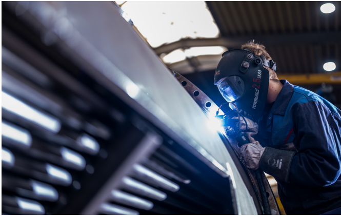
Anschweißen eines Flansches aus P265 GH eines Wärmetauschers mit einem Durchmesser von 2,30 Metern mit dem tigSpeed System.
