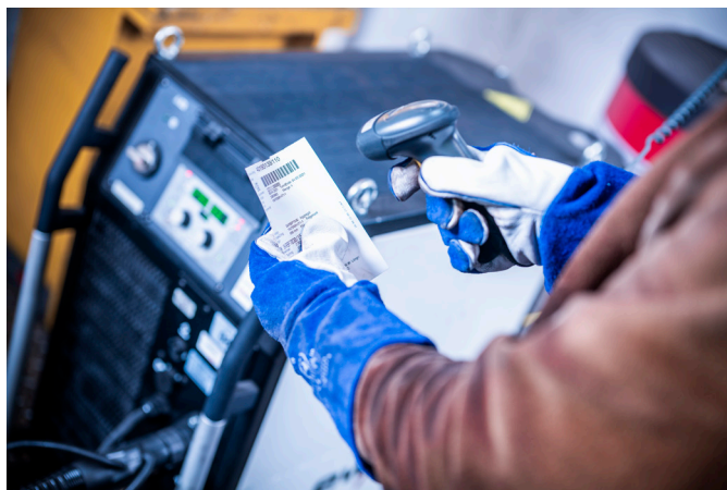
Der Xbutton enthält sämtliche Informationen zu den Schweißverfahren und den Schweißparametern. Auch die Identifikation der Schweißer ist damit möglich.
