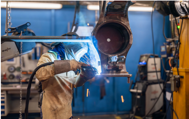
Für die Fertigung der Drehgestelle kommt überwiegend das MAG-Schweißverfahren zum Einsatz.
