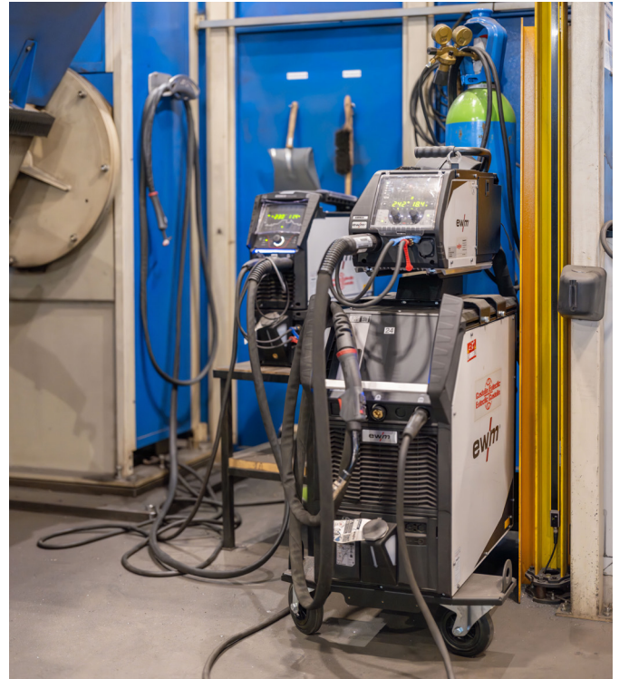
Die Titan XQ 400 (rechts) bietet durch ihre moderne Invertertechnologie und die Integration aller Schweißprozesse optimale Voraussetzungen für präzises und effizientes Schweißen.
