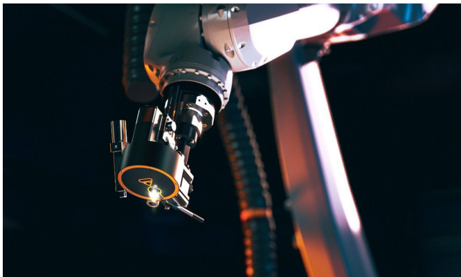
Die WAAM-Technologie nutzt den Schweißlichtbogen als Energiequelle, um einen Metalldraht zu schmelzen.
