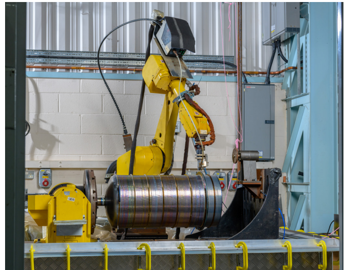
Das geschmolzene Material wird Schicht für Schicht aufgetragen, bis das Bauteil fertiggestellt ist. Der gesamte Prozess wird mit Robotern koordiniert.
