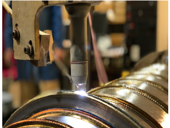
WAAM3D verwendet derzeit die Tetrax 352 und 552 für das Plasmaschweißen, da sie eine präzise Steuerung des Lichtbogens und damit eine gleichmäßige, reproduzierbare Schichtbildung ermöglichen.
