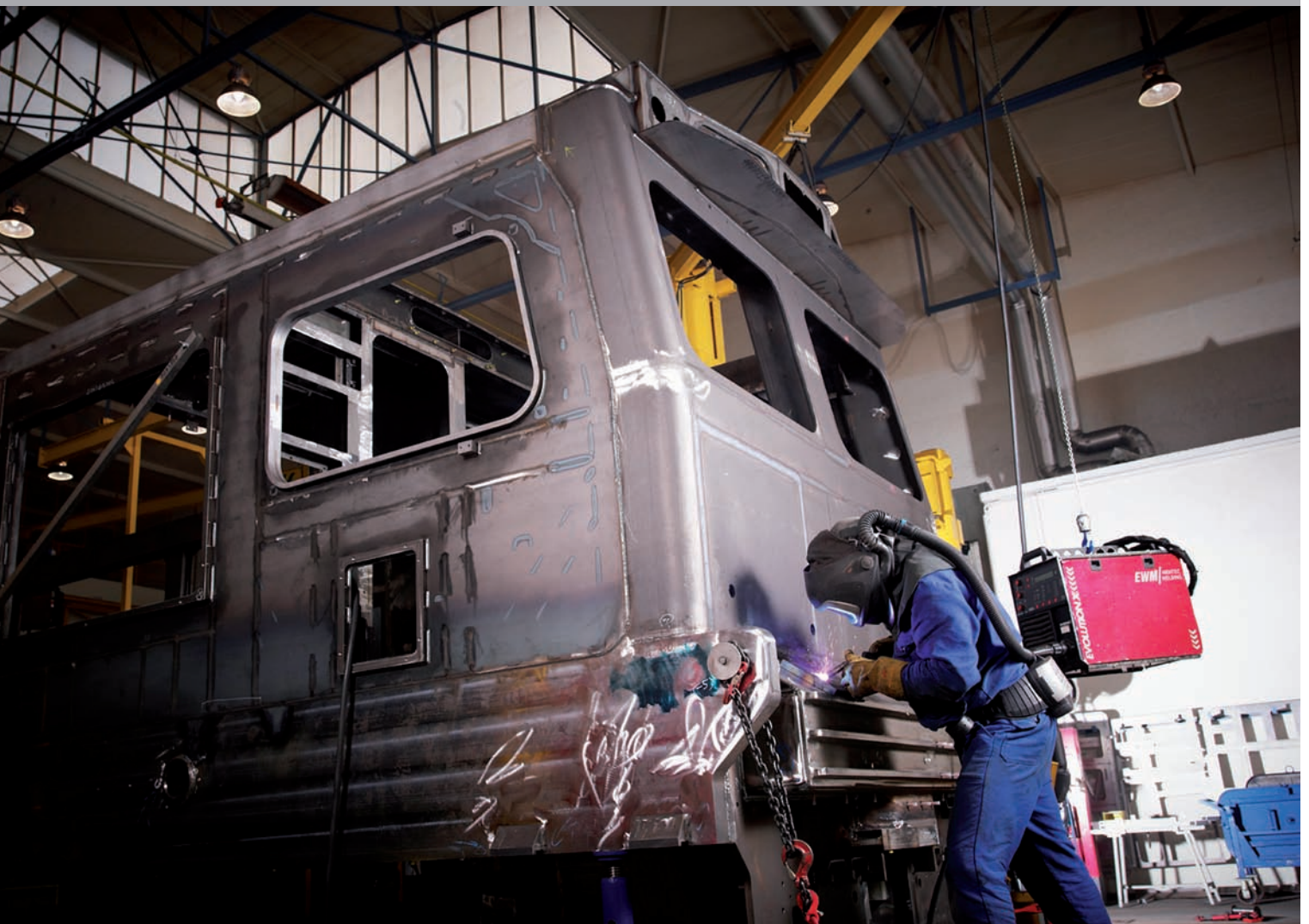
/ Effizientes Schweißen mit forceArc® am Lokkasten für schwere Güterzuglokomotive.
