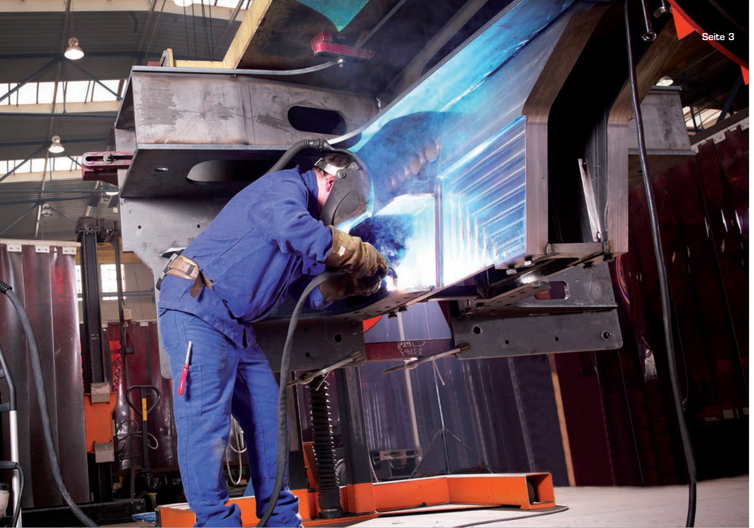
/ Perfektes Schweißen mit forceArc® am Kopfstück für schwere Güterzuglokomotive.
