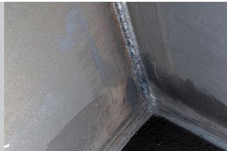
/ Physik der Schweißtechnik steht Kopf: Die Inspektion im Innern der Schweißkonstruktion bringt es an den Tag – Kehlnähte, die der Bewertungsgruppe B nach ISO 5817 entsprechen, mit definierter Hohlkehle und entsprechendem Überhang – auch das a-Maß entspricht mit drei Millimetern dem geforderten Wert der Norm. Somit ist es nun möglich, bestimmte Nähte nur noch von einer Seite zu schweißen. Die Gegenlage entsteht dabei „von alleine“
